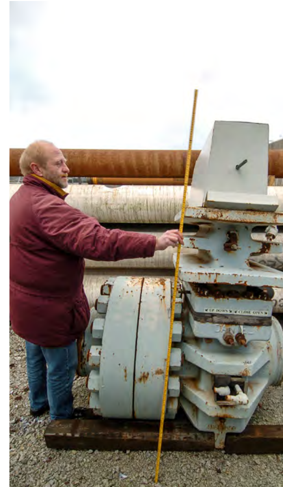
Denne målestasjon for gass mottok Norsk oljemuseum da Friggfeltet ble nedstengt. Modellen ble sendt fra Totals hovedkontor i Paris til Total i Dusavik Stavanger. Foto: Jan A. Tjemsland, Norsk oljemuseum
